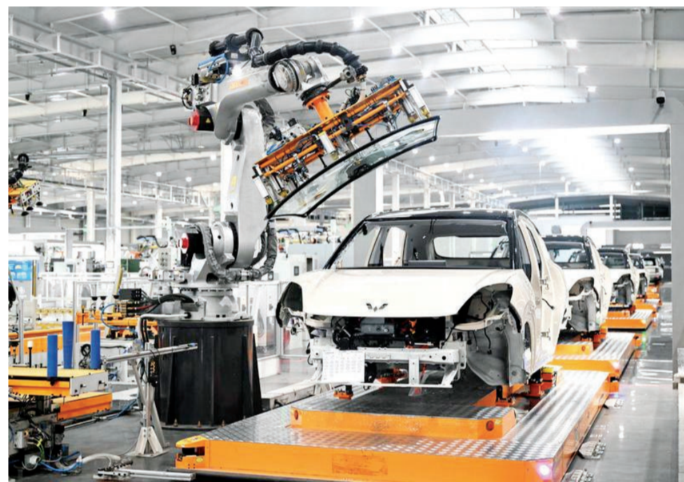
↑9月9日，工业机器人在上汽通用五菱“岛式”精益智造工厂里进行汽车零部件装配作业。
